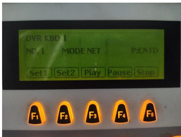
(4) Press 【Shift】 + 【Site】 , and input the IP address of PTZ. After setting, Press 【Shift】 + 【Site】 to exit setting.
